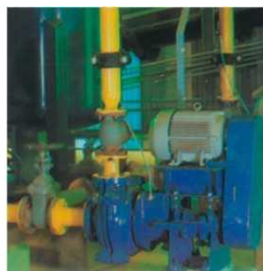
75DKM渣浆泵在金矿的应用 75DKM slurry pump on duty in a gold concentrating plant pumping ground ore slurry to a flotation circuit. Применение шламового насоса 75DKM на золотом руднике
