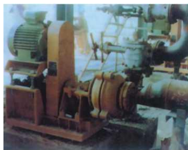
25DKB渣浆泵在氧化铝厂的应用 25DKB slurry pump handling hot caustic slurry in an alumina plant. Применение шламового насоса 25DKB на корундовом заводе
